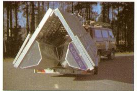
SJÖNO 550 transporteras ihopfälld, sjösättningen går på under en minut tack vare en genial konstruktion
